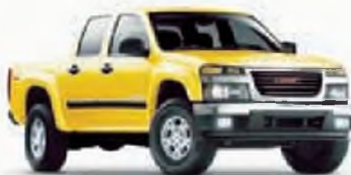
▲ Figura 12.31 Una camioneta en su mayoría plástica. Esta camioneta contiene manijas para las puertas y para choques hechos de plástico policarbonato-polibutileno. Los pigmentos de color se incorporan durante la fabricación del plástico, lo que evita la necesidad de pintarlo.
